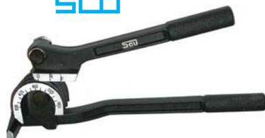
Tipo in fusione. Per curvare da 0° a 180° tubi di alluminio, ottone, rame ricotto e acciaio sottile. Eseguce curvatures di tubi con diametri diversi, senza intercambio di matrice.
