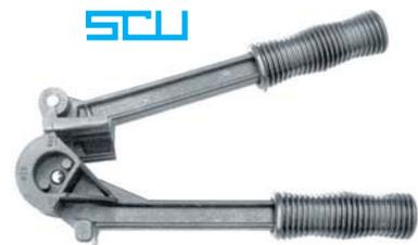
Tipo in fibra di vetro, infrangibile. Per curvare da 0° a 180° tubi di alluminio, ottone, rame ricotto e acciaio sottile. Eseguce curvatures di tubi con quattro diametri diversi, senza intercambio di matrice.
